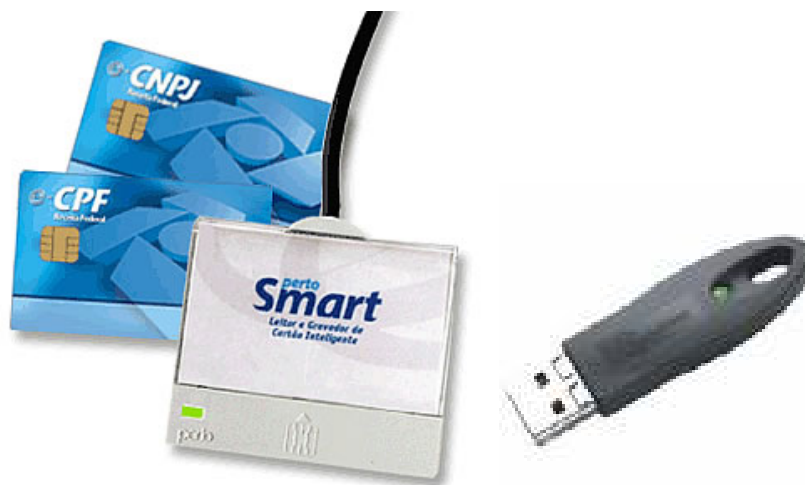
Figura 3.8: Smart Cards (e-CPF e e-CNPJ), leitora de Smart Cards e Token padrão ICP.
